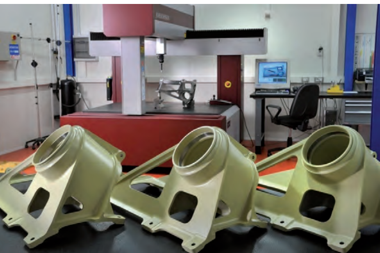
Sala metrologica di Merletti Aerospace. Macchina di misura 3D Johansson con interfaccia diretta Catia V5.
